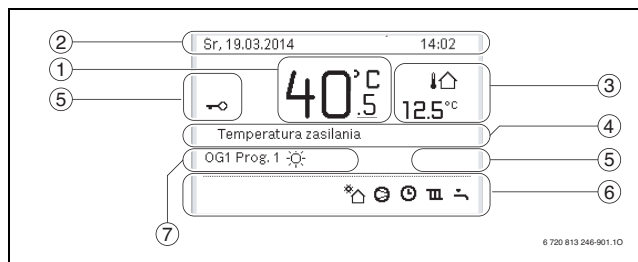
Rys. 6 Symbole na ekranie wskazania standardowego (przykładowy wyświetlacz)
